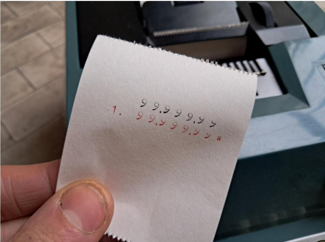
1. Su questa macchina un leveraggio messo in tensione da una molla preme su una leva che sgancia il "settore dei riporti" della prima cifra del contatore, azionandolo forzatamente. Questo porta la macchina ad immagazzinare l'unità del riporto direttamente nel totalizzatore, evitando di scriverlo sul nastro.
